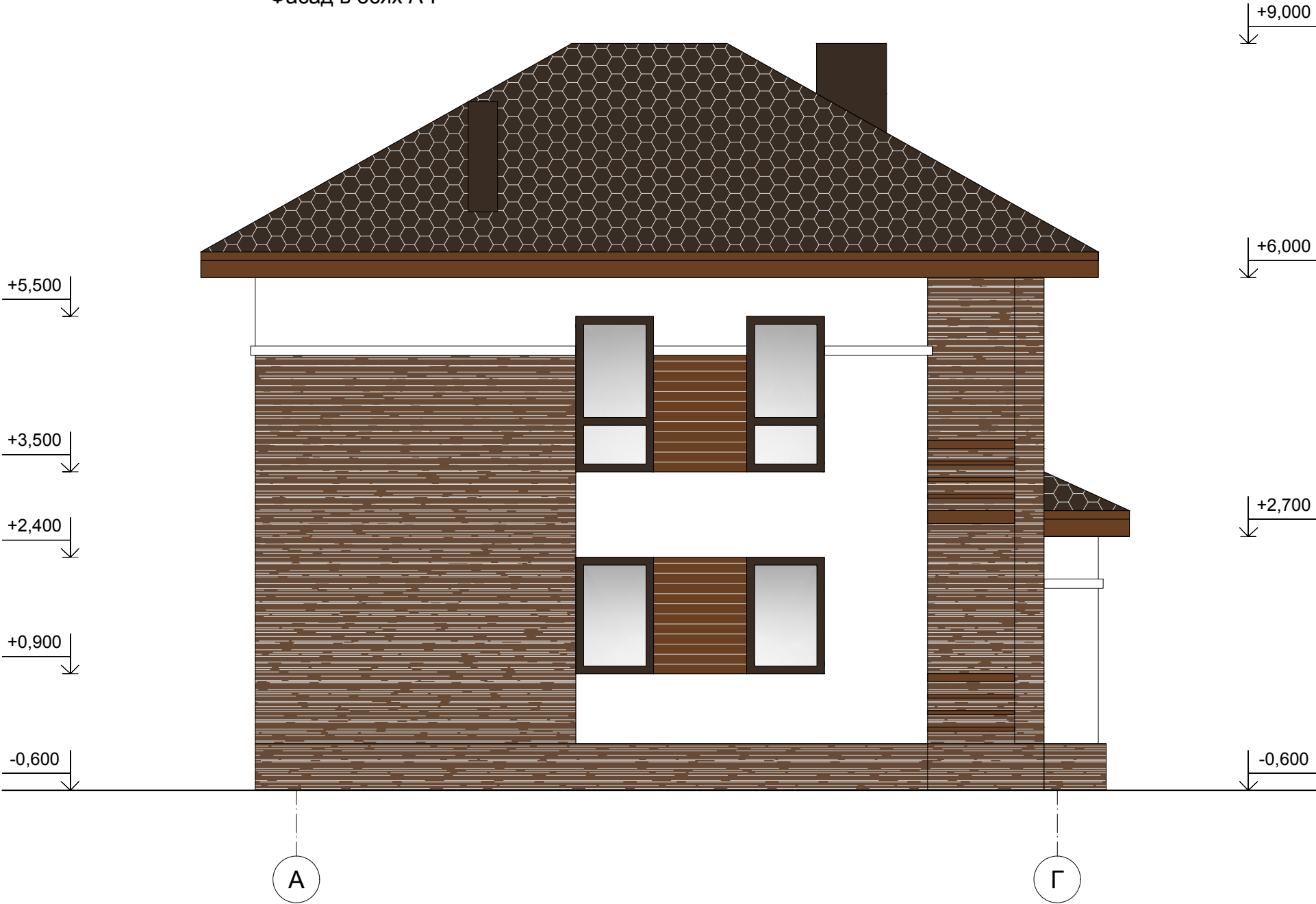
Фасад в осях А-Г
